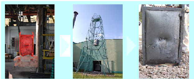
Feuer- und Sturzttest bei TU (Technische Universität Danzig)
