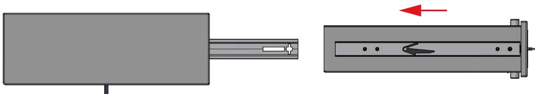
Halten Sie die Schublade waagrecht und schieben Sie die an der Schublade befestigten inneren Schienen in die äußeren Schienen im Korpus. Schieben Sie die Schublade vollständig in den Korpus bis die Schienen einrasten. Ziehen Sie die Schublade zum Test noch einmal vorsichtig vollständig aus.
