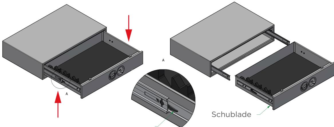
Zum Entfernen der Schublade, ziehen Sie diese ganz heraus bis in den Schienen jeweils ein schwarzer Hebel zu sehen ist. Drücken Sie beide Hebel gleichzeitig, gegenläufig, (einen nach oben einen nach unten) während Sie die Schublade weiter herausziehen. Bitte beachten Sie, dass nach der Trennung der Schienen das volle Gewicht der Schublade gehalten werden muss.
